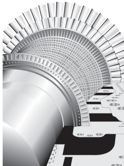
(β) Άξονας ατμοστροβίλου με περιστρεφόμενα πτερύγια
