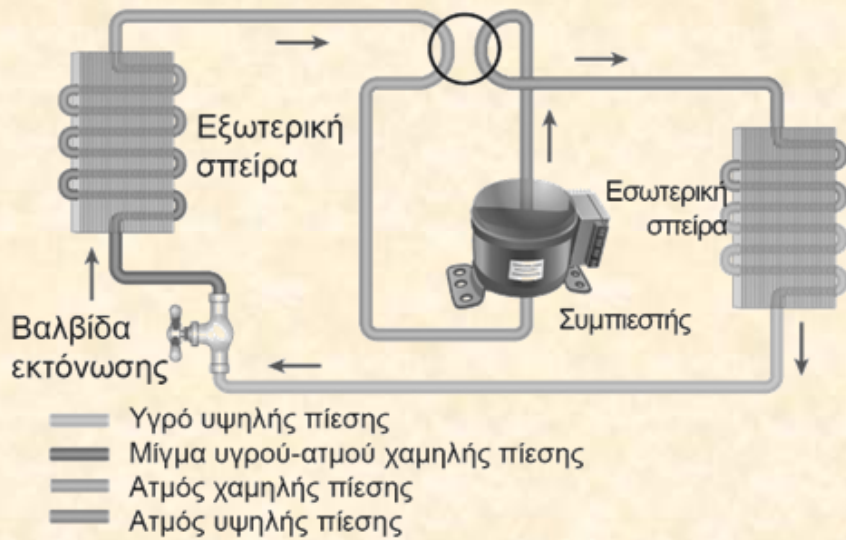
Λειτουργία αντλίας θερμότητας - Θέρμανση Βαλβίδα αναστροφής
