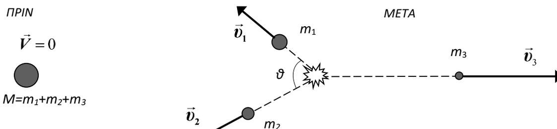
Διατήρηση ορμής (2 εξισώσεις):  $\vec{p}_1 + \vec{p}_2 + \vec{p}_3 = 0 \Rightarrow \vec{p}_3 = -(\vec{p}_1 + \vec{p}_2)$
