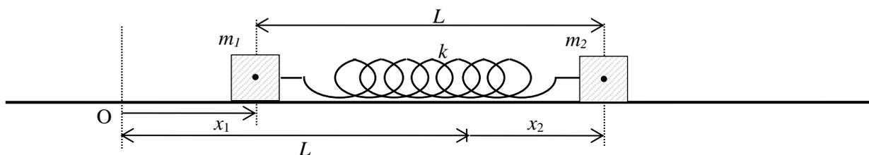
$$\begin{aligned} (1) \quad -k(x_1 - x_2) &= m_1 a_1 & \xrightarrow{(1) + (2)} & 0 = MA & \text{ευθύγραμμη ομαλή} \\ (2) \quad k(x_1 - x_2) &= m_2 a_2 & \xrightarrow{m_2(1) - m_1(2)} & -kx = \mu a & \text{απλή αρμονική ταλάντωση} \end{aligned}$$
