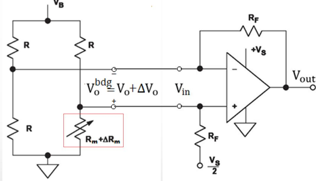
Τάξη μεγέθους εξόδου γέφυρας       $\Delta V_o \sim 1 \text{ mV}$
