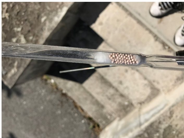
Σχήμα 7. Το προσροφητικό υλικό στερεωμένο σε μαλλί χαλαζία, «φορτωμένο» στον γυάλινο αντιδραστήρα.
