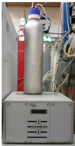
Σχήμα 9.4. Σύστημα καταλυτικού αντιδραστήρα σταθεροποιημένης κλίνης και σύστημα τροφοδοσίας μείγματος γλυκερόλης.
