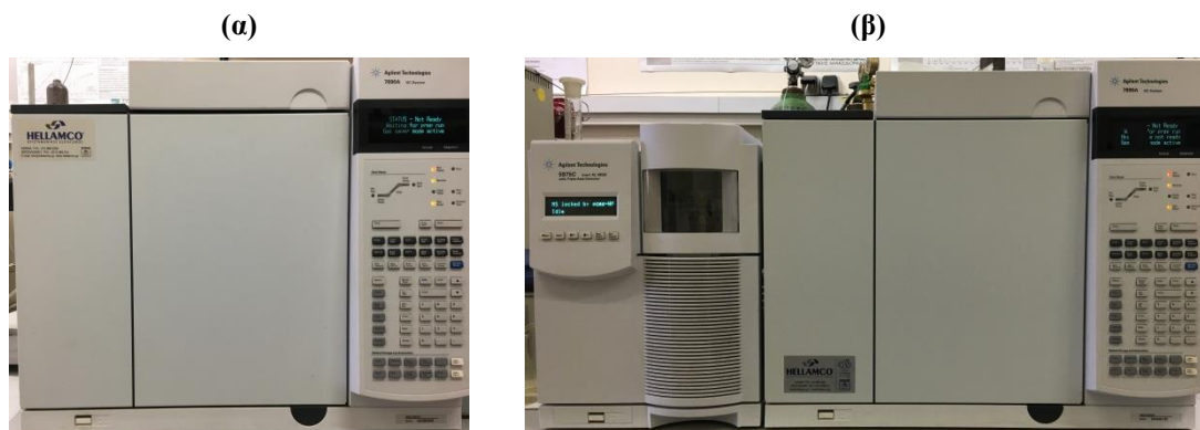
Σχήμα 9.5. Συστήματα ανάλυσης αέριων και υγρών προϊόντων: (α) Αέριος χρωματογράφος 7890A και (β) Αέριος χρωματογράφος συνδεδεμένος απευθείας με φασματογράφο μάζας.
