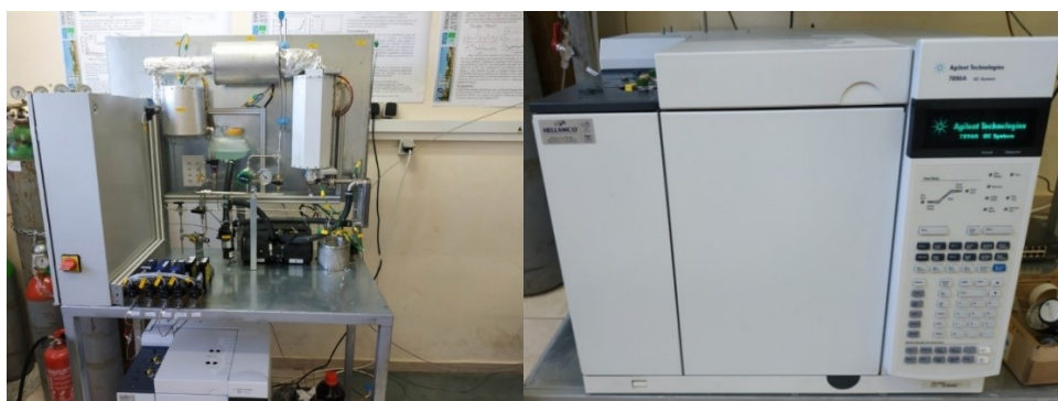
Σχήμα 6.18: Φωτογραφίες της καταλυτικής μονάδας και του χρωματογράφου, όπου γίνεται ανάλυση του αερίου μίγματος.
