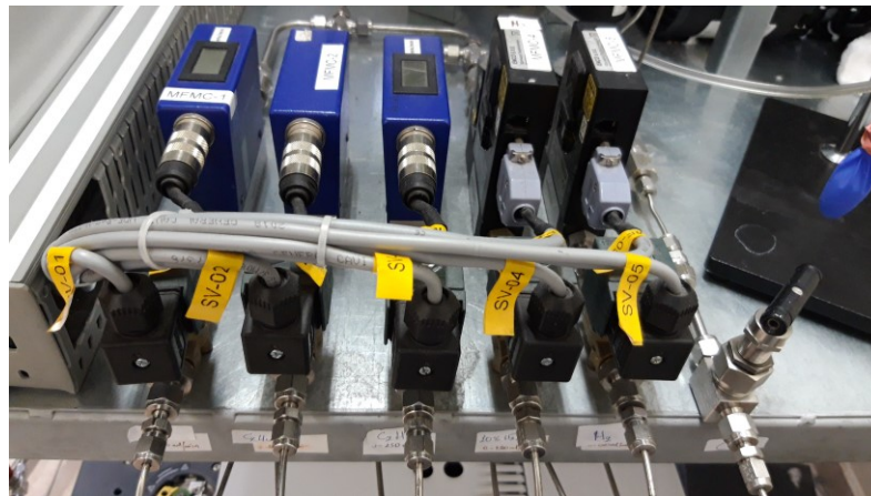
Ροόμετρα μάζας και ηλεκτρονικές βαλβίδες εισαγωγή αερίων.
