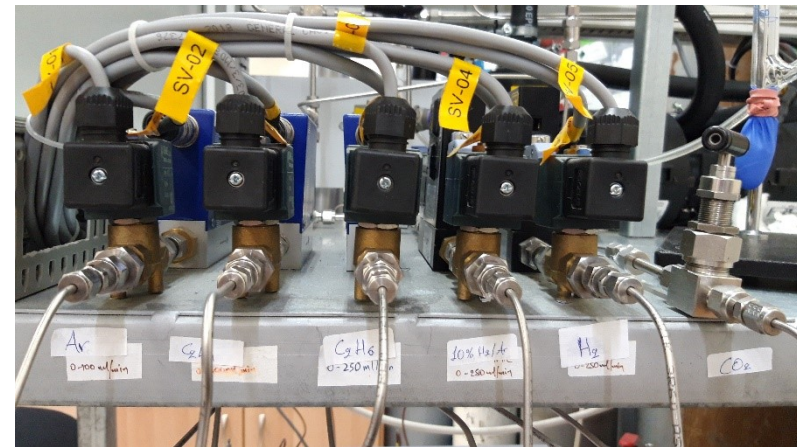
Ροόμετρα μάζας και ηλεκτρονικές βαλβίδες εισαγωγή αερίων.
