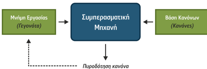
Σχήμα 3.4 Τυπική Δομή και λειτουργία Συστημάτων Κανόνων
