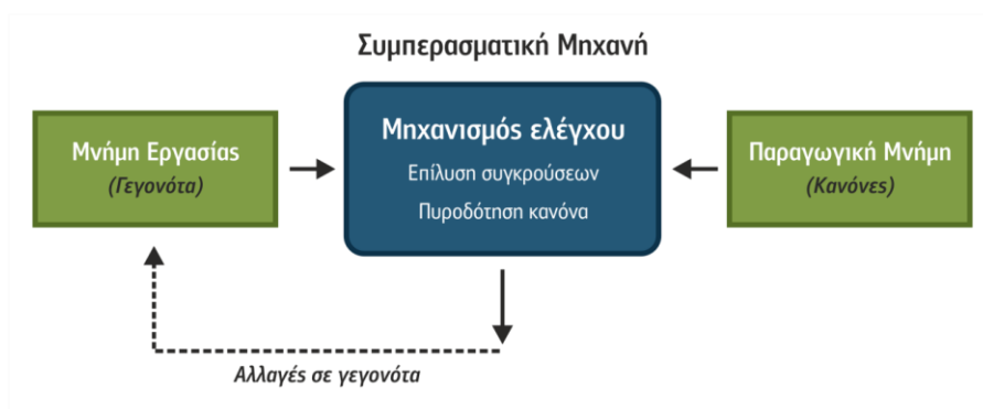
Σχήμα 3.7 Δομή και λειτουργία Συστημάτων Παραγωγής
