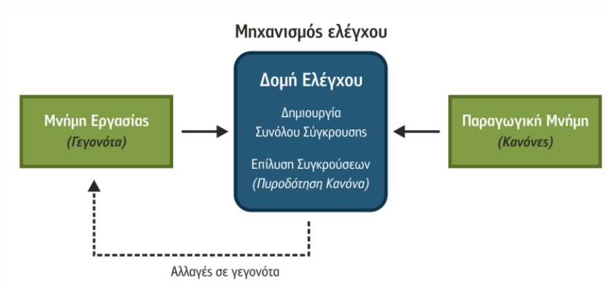
Σχήμα 3.8 Τα βήματα ενός κύκλου λειτουργίας
