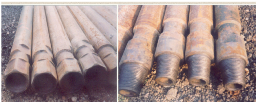
Εικόνα 15. Διατρητικά στελέχη από βελτιωμένο χάλυβα (μήκους 7.62 μέτρα)
