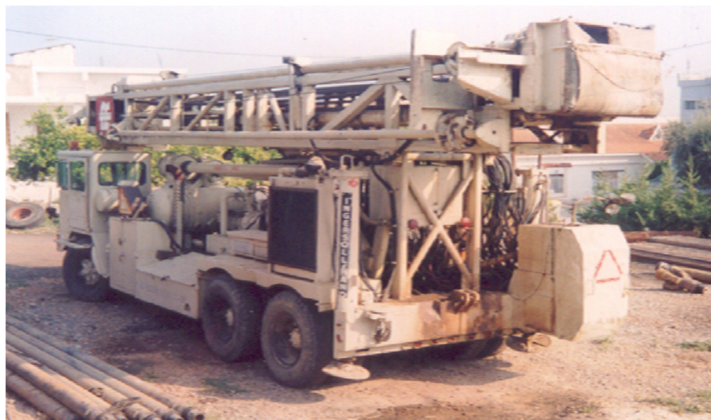
Εικόνα 14. Γεωτρύπανο με δυνατότητα διάνοιξης γεώτρησης βάθους 915 m
