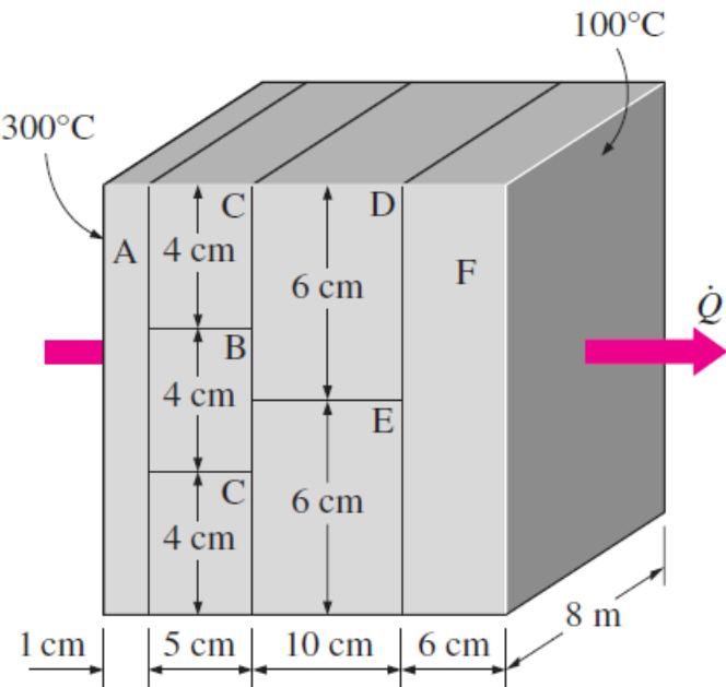
Θεωρείστε έναν τοίχο ύψους 5 m, βάθους 8 m και πάχους 0.22 m, όπως φαίνεται στο διπλανό σχήμα. Οι συντελεστές θερμικής αγωγιμότητας των υλικών που δομούν το συγκεκριμένο τοίχο είναι:
