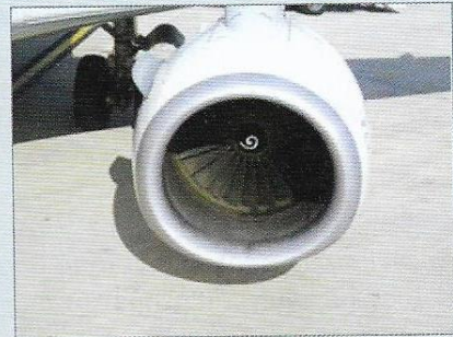
Σχήμα 5-27: Διαχύτης σε κινητήρα τζετ, όπως αυτός που μελετάται στο Παράδειγμα 5-4. Φωτογραφία: Yunus Cengel
