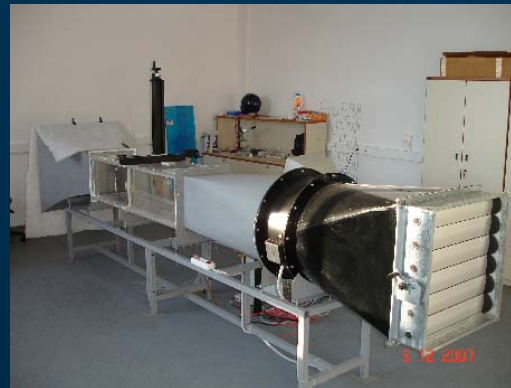
Αεροσήραγκα χαμηλής ταχύτητας
