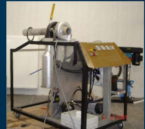
Ιδιοκατασκευή μικρού αεριοστροβίλου
