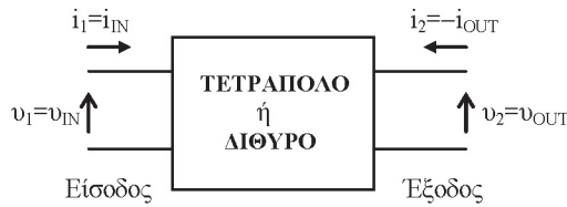
Σχήμα 3.68. Συμβολισμός τετράπολου και ορισμός τάσεων και ρευμάτων στα άκρα του.
