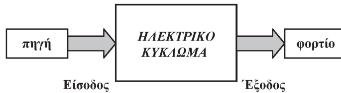
Σχήμα 1.1. Τυπική διάταξη συνδεδεμένου ηλεκτρικού κυκλώματος με πηγή στην είσοδο και φορτίο στην έξοδο.
