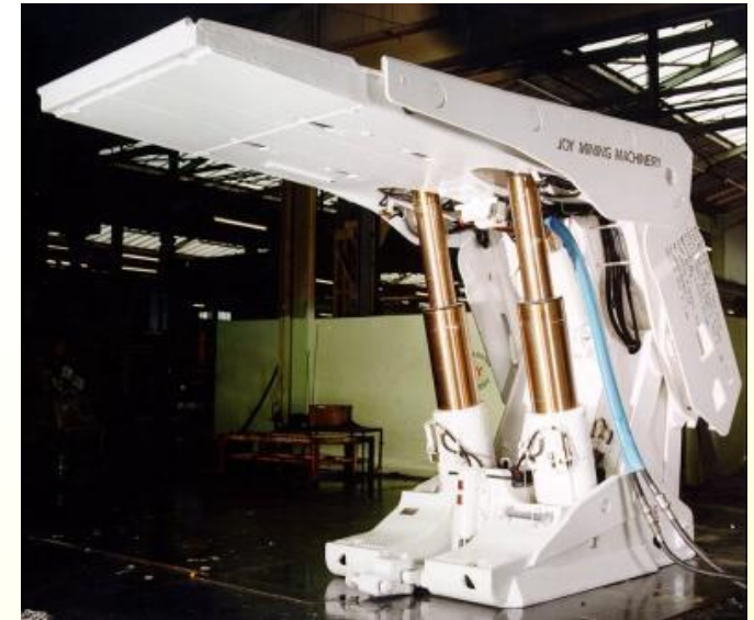
Σύγχρονο στοιχείο βηματίζουσας υδραυλικής υποστήριξης με δυο σκέλη-υποστηλώματα
