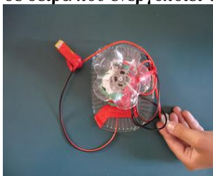
Σχήμα 6: κύκλωμα σε σειρά που ενεργοποιεί τη λειτουργία μοτέρ.
