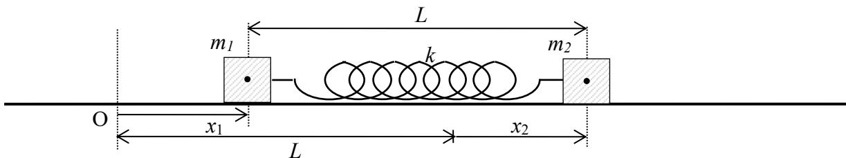
$$(1) \quad k(x_2 - x_1) = m_1 a_1 \quad \xrightarrow{(1)+(2)} \quad 0 = MA \quad \text{ευθύγραμμη ομαλή} \\ (2) \quad -k(x_2 - x_1) = m_2 a_2 \quad \xrightarrow{m_1(2) - m_2(1)} \quad -kx = \mu a \quad \text{απλή αρμονική ταλάντωση με } \omega = \sqrt{\frac{k}{\mu}}$$
