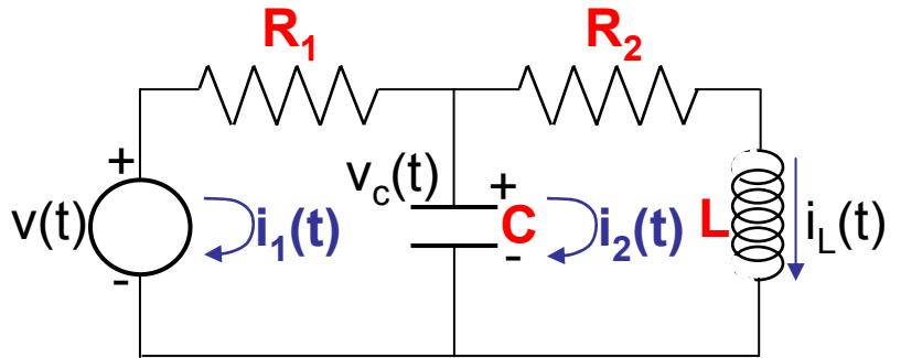
$$R_1 i_1(t) + \frac{1}{C} \int_0^t i_1(t) dt - \frac{1}{C} \int_0^t i_2(t) dt = v(t)$$
