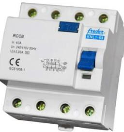
Στον ηλεκτρικό πίνακα του εργαστηρίου έχει τοποθετηθεί Αυτόματος Διακόπτης Διαφυγής Ρεύματος που ανιχνεύει διαρροή ρεύματος ως προς τη γη άνω των 30mA. Σε τακτά χρονικά διαστήματα γίνεται ο έλεγχος του με το μπουτόν δοκιμής που διαθέτει.
