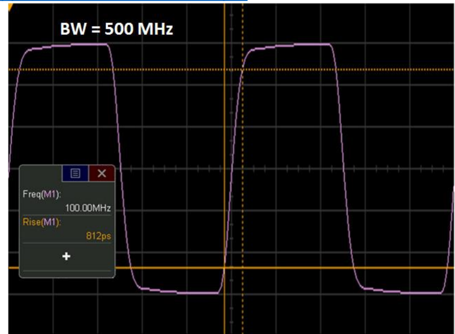
100-MHz παλμοσειρά σε οθόνη παλμογράφου με BW 500-MHz
