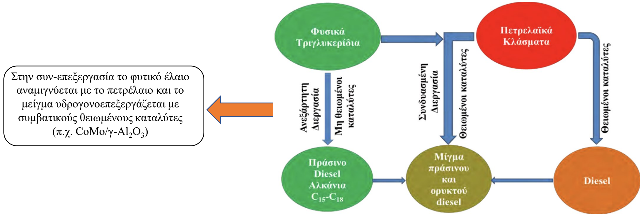
Σχήμα 12: Στρατηγικές υδρογονοεπεξεργασίας για τη βιομηχανική παραγωγή πράσινου ντίζελ με εκλεκτική αποξυγόνωση των φυσικών τριγλυκεριδίων.
