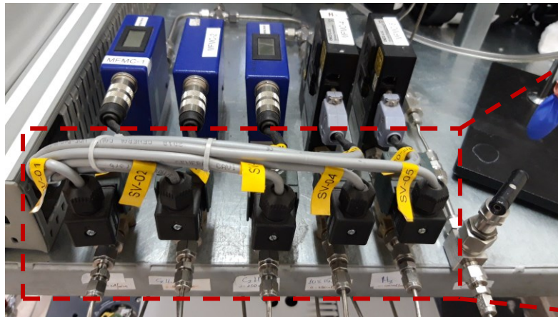
Σχήμα 4. Ροόμετρα μάζας και ηλεκτρονικές βαλβίδες εισαγωγή αερίων.
