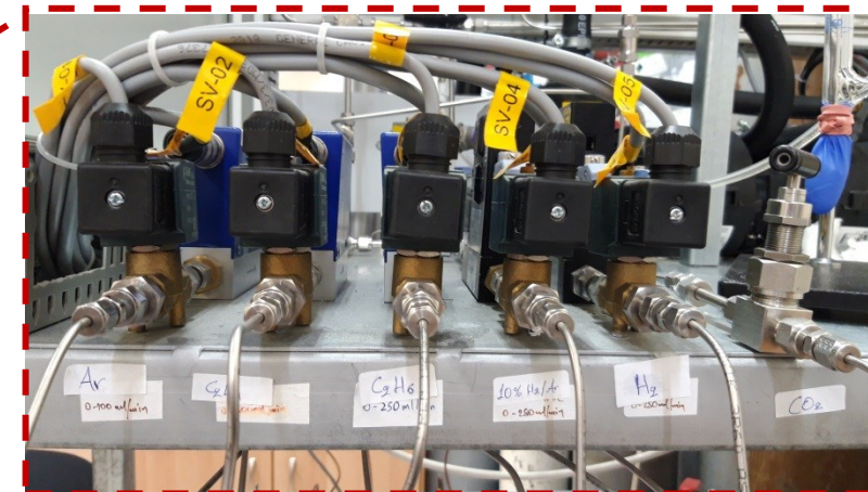
Σχήμα 4. Ροόμετρα μάζας και ηλεκτρονικές βαλβίδες εισαγωγή αερίων.
