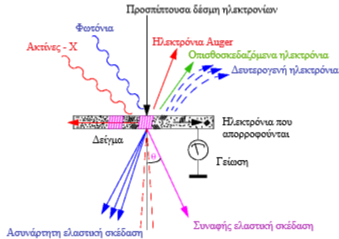
Σχήμα 3.7. Αλληλεπίδραση δέσμης ηλεκτρονίων και υλικού.
