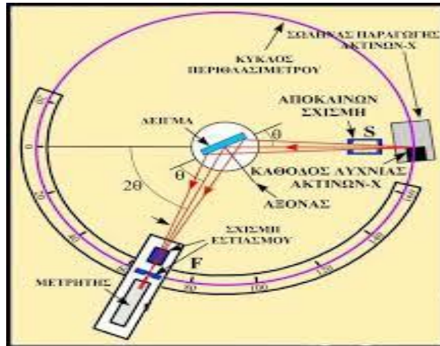
Σχήμα 3.4. Σχηματική απεικόνιση της διάταξης περιθλασίμετρου ακτίνων-X.
